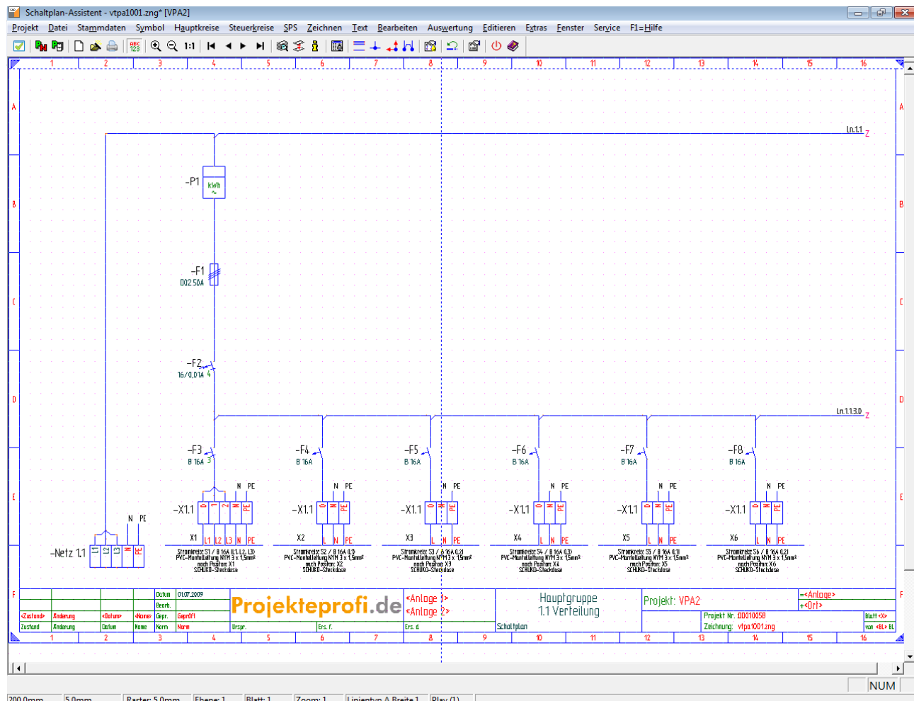
Abbildung 2.4.1: Automatisch generierter Verteilerplan (einpölig)
